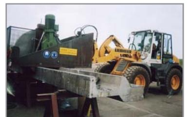
Radlader mit angebauter Säge
