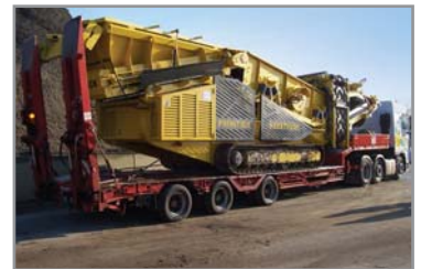
Transport einer mobilen Siebanlage
